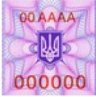
Нумерация бланков, как одна из степеней защиты, производится способом высокой печати с применением специальных красок (нумерация – один из основных методов учета и защиты бланков).
