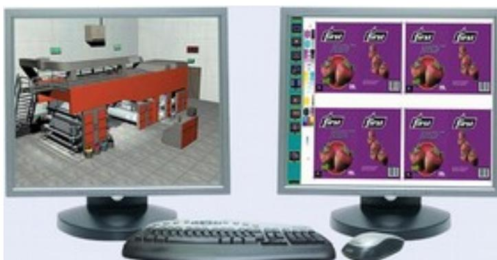
С помощью панели управления на мониторе оператор может контролировать процессы печати, учитывая заданные параметры. Интерактивная диагностика выявляет возможные проблемы вместе с объяснениями и причинами. А при контроле полученных оттисков, возможно просмотреть печатный лист с масштабированием в любой его части, что позволяет проверить все характеристики печати.
