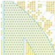
Графический элемент защиты бланков выполнен с помощью специальных растровых элементов (для воспроизведения полутонового изображения используются специальные линейные растры).
